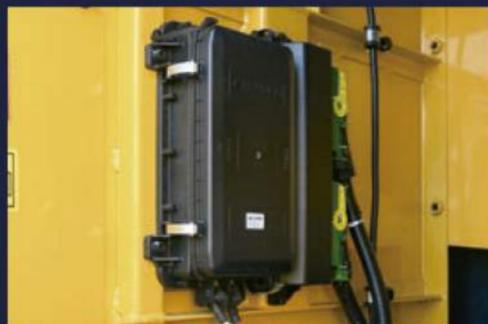
Caixa elétrica impermeável e resistente a altas temperaturas
