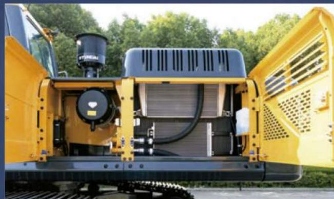
Arranjo centralizado dos filtros para facilitar a manutenção e filtro separador de alta capacidade
